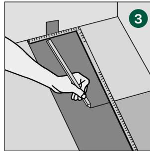
Legen Sie die letzte Diele mit der Unterseite nach oben, die Stirnseite ohne Verriegelungsleiste der Wand zugewandt. Der Abstand zur Wand soll ca. 5 mm betragen. Markieren Sie die Stelle, an der die Diele abgesägt werden soll.
