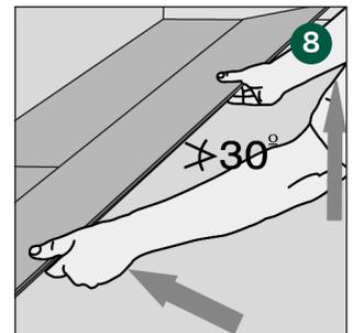
Heben Sie die Diele (zusammen mit der vorher gelegten Diele in der gleichen Reihe) etwa 30 mm an der Vorderkante an und drücken Sie diese in die Dielenreihe hinein. Wenn die Längskanten aufeinander stoßen, legen Sie die Dielen auf den Boden.
