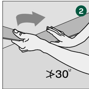
Drücken Sie die nächste Bodendiele im Winkel an die erste Diele und drücken Sie anschließend die Diele auf den Boden. Verfahren Sie in der gleichen Weise mit der gesamten ersten Reihe.
