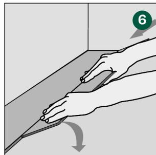
Drücken Sie die Längsseite der ersten Diele der zweiten Reihe im Winkel gegen die davor liegende Diele. Pressen Sie die Diele weiter nach vorne und legen Sie sie gleichzeitig an den Boden an.
