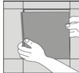
Verwenden Sie einen Kontaktkleber. Tragen Sie den Kleber gemäß Anleitung auf. Drücken Sie die Fliese nach unten. Entfernen Sie überflüssigen Klebstoff.
