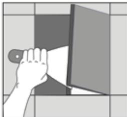
Heben Sie die Fliese von der Mitte zu den Seiten mit Hilfe eines Spachtels an. Durch diese Methode wird vermieden, dass die benachbarten Fliesen beschädigt werden.
