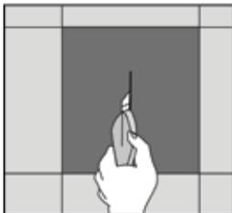
Um die Fliese zu entfernen, müssen Sie die Mitte mit einem Messer aufschneiden.
