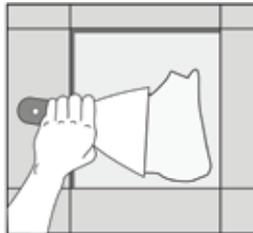
Versuchen Sie die Fliese zu entfernen, ohne den Unterboden zu beschädigen. Falls dies nicht möglich ist, sollte der Unterboden danach mit einer geeigneten Ausgleichsmasse aufgefüllt werden. Gehen Sie mit besonderer Vorsicht vor, um sicher zu stellen, dass danach der Untergrund wieder absolut eben und glatt ist.
